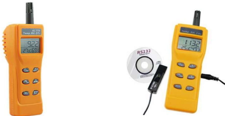
Figura 8: Medidor AZ7755 de CO 2 usado en los ensayos.
