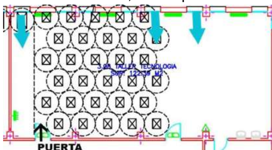
Figura 18: Ventilación en aula de 1ºBHCS (taller). Las flechas azules indican las ventanas que se deben abrir.
