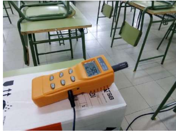
Figuras 9: Colocación del medidor en la clase a una altura de 1m aproximadamente.
