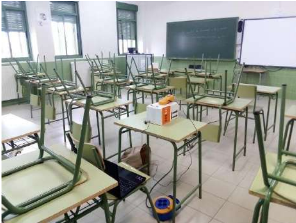
Figuras 9: Colocación del medidor en la clase a una altura de 1m aproximadamente.
